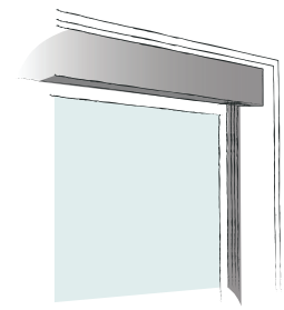
INSTALLATIE OP MUURBALKEN, MET RAILS DIE OP DE ZIJKANT BEVESTIGD ZIJN
